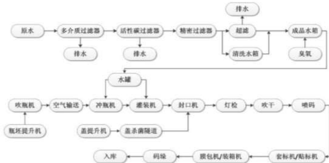
图 6-1 矿泉水灌装生产工艺流程图
